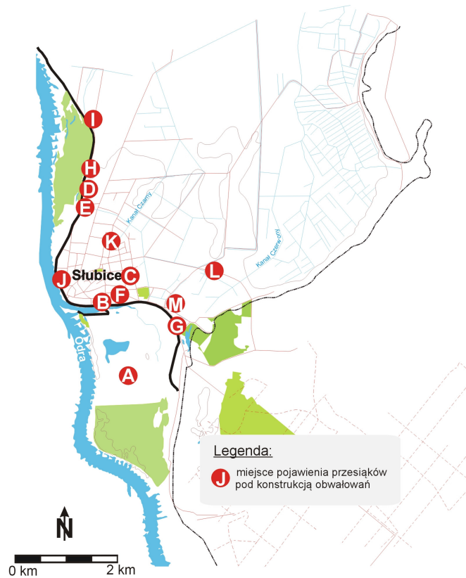
Rys. 8. Miejsca pojawiania się przesiąków pod konstrukcją wałów podczas wezbrania powodziowego w V÷VI.2010 r.
